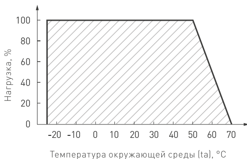
Рис. 7. Максимальная допустимая нагрузка, % от мощности источника
